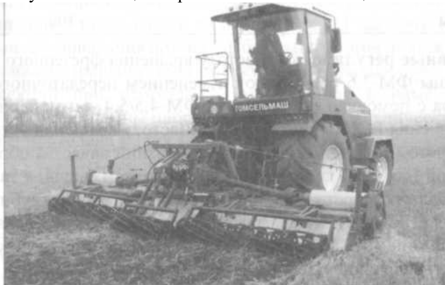
Рис. 2. Фрезерная машина ФМ-4,5/5,4 (с лапами) на обработке засоренного поля со стерней ячменя
